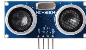
Resim 5.16: Ultrasonik uzaklık algılayıcı
