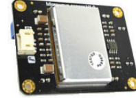
Resim 5.13: Mikrodalga hareket dedektörü algılayıcı
