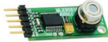
Resim 5.10: Kızılötesi termometre algılayıcı
